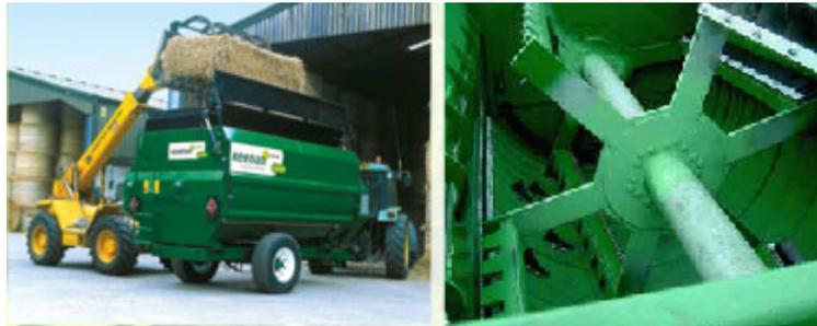
Al igual que los modelos Keenan anteriores, el Mech Fiber se basa en una paleta central para mezclar (en rojo) y un sinfín para La descarga (en verde).
